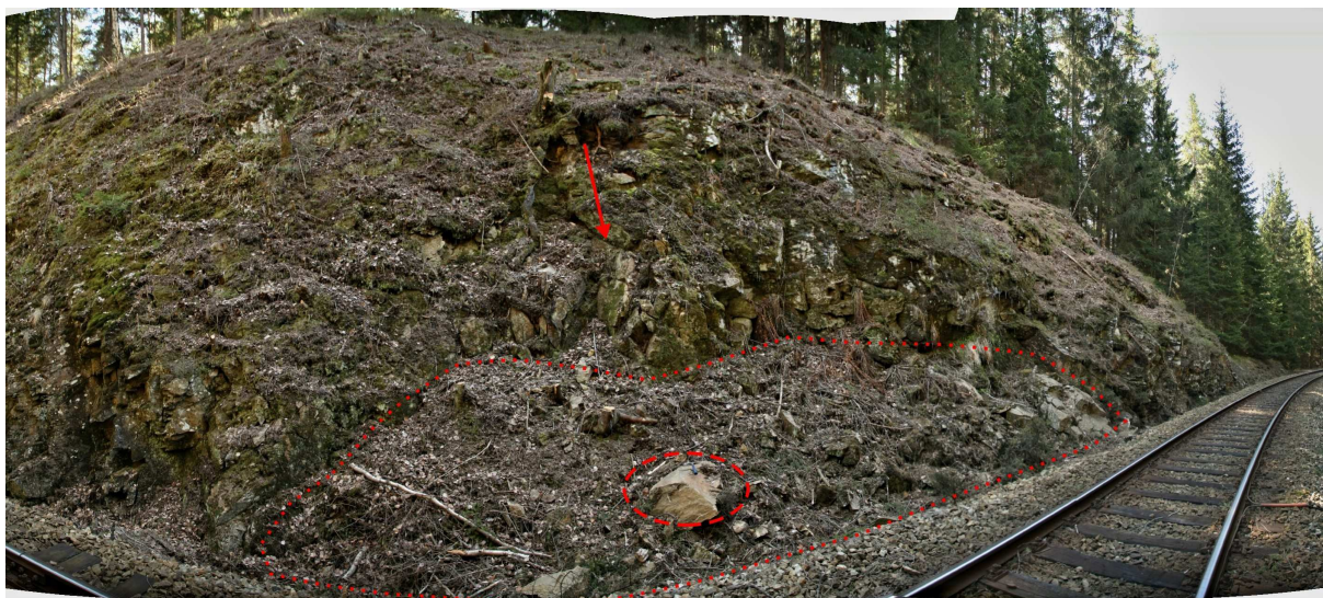
Foto 21-2 Příklad aktivních projevů svahového pohybu sesypáváním na cca km 36,398. Šipka označuje zdrojovou oblast sesypaného skalního bloku označeném elipsou. Tečkovaný polygon pak ohraničuje akumulaci ospyvého kužele.
