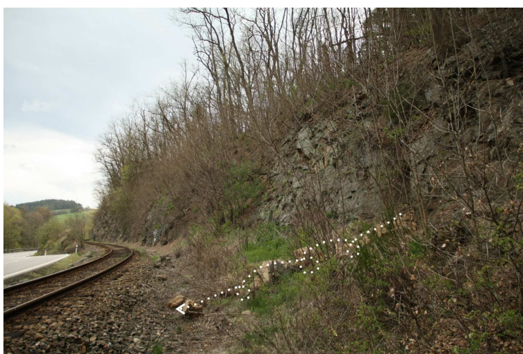
Foto 4-6 Pohled ze strany na trajektorii odvaleného skalního klínu na cca km 7,940. Valivým pohybem po povrchu osypu se skalní objekty transportovaly k okraji kolejiště.
