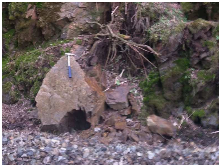
Foto 1-1 Skalní stěna zářezu má potenciál k projevu svahového pohybu zejména sesypáváním zejména v poruchových zónách a o objemu sutě do 1 m 3 .
