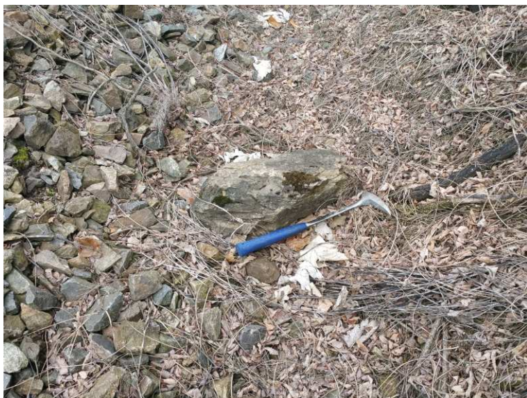
Foto 3-4 Snímek dokumentuje plošný skalní objekt oddělený od masivu dopadnuvší na okraj ohroženého prostoru. Nelze ale vyloučit dopady větších skalních bloků přímo do prostoru kolejiště.
