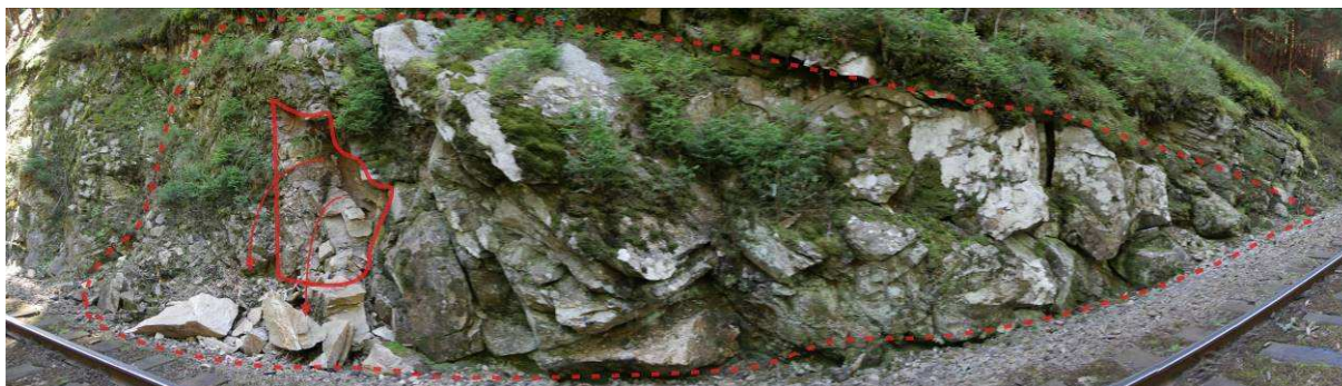
Foto 25-2 Příklad aktivních projevů svahového pohybu sesypáváním. Polygon plnou čarou označuje zdrojovou oblast sesypaných skalních bloků. Přerušovanou čarou je označena rozvolněná oblast skalního masivu označena ČGS 25-1.
