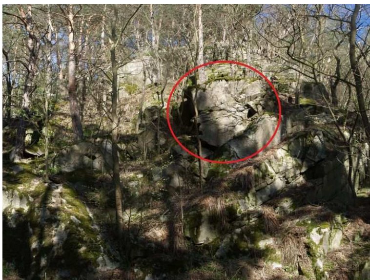
Foto 12-3 ČGS dokumentovala potenciálně nestabilní objekt nacházející se v horní části posuzovaného svahu, jehož objem je cca 1,5 m 3 .
